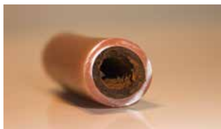
Versprödetes und verschlammtes Bodenheizungsrohr.
