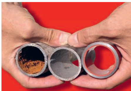
Von links: Verrostetes Rohr, gereinigtes Rohr, beschichtetes Rohr.
