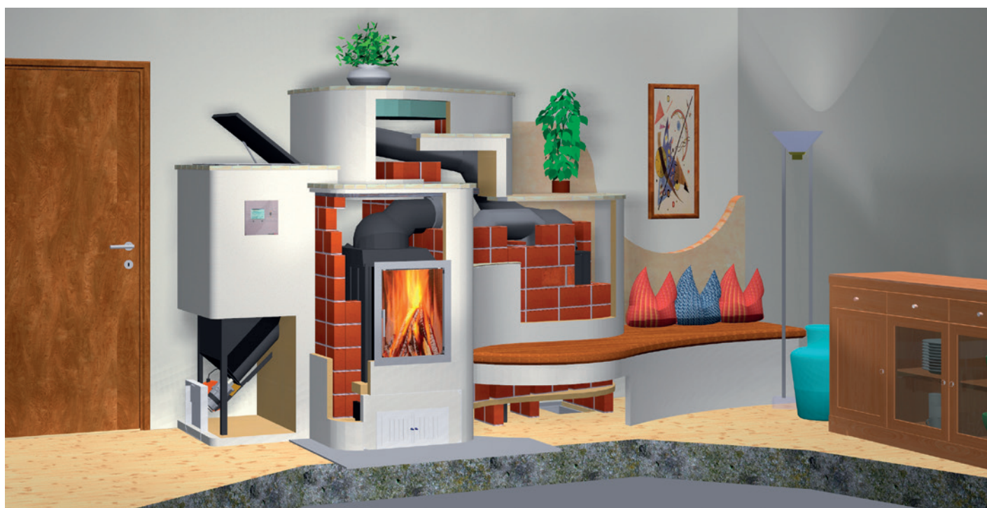
Schema eines Stubenofens, der mit Pellets und Stückholz heizen kann. Links der kleine Pellettank.
