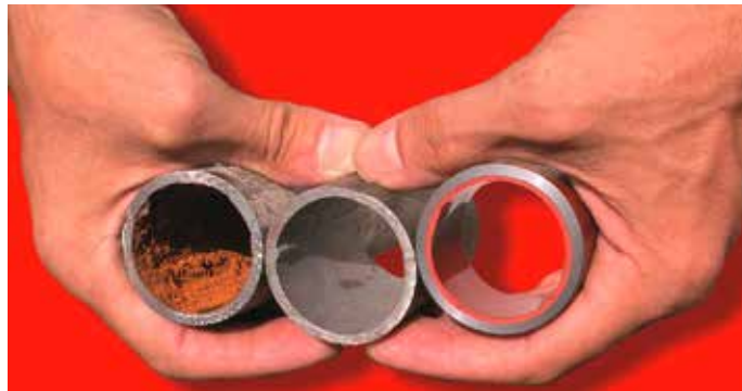
Von links: Verrostetes Rohr, gereinigtes Rohr, beschichtetes Rohr.
