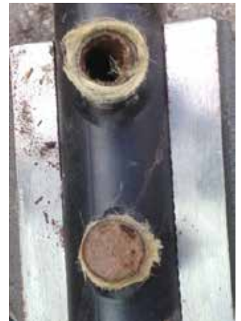
Selbst einen Totalverschluss (unten) entfernt das Girojet-System.
