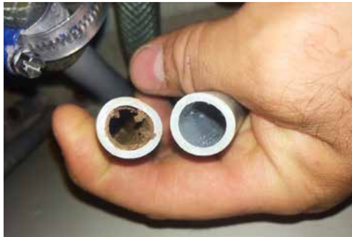
Was für ein frappanter Unterschied: Mit dem Girojet-Verfahren gereinigte Rohre (links vorher, rechts nachher) sorgen für Wärme. Interessiert? Dann die Bodenheizung jetzt kostenlos überprüfen lassen.
